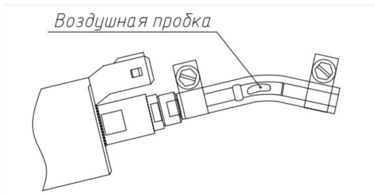
Рис. 7 а) Неправильная прокладка магистрали—образование воздушных пробок
